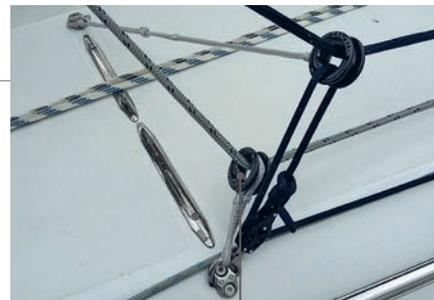
Les écoutes de foc sont réglées à l'aide d'anneaux de friction ; solution moderne, simple et efficace. Les anneaux de friction n'entrent pas en contact avec le pont car ils sont maintenus en hauteur par l'écoute de GV.
