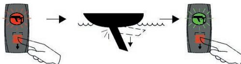
Contrôle simple par bouton sécurisé : au poste de barre : un bouton très intuitif permet de contrôler la position de la quille. L'utilisation accidentelle est évitée par un double verrouillage.
