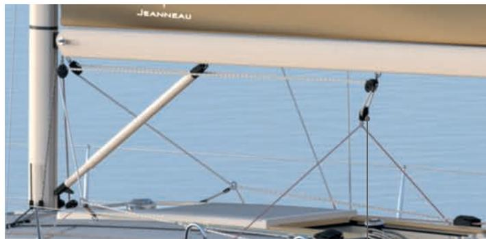
Voici le système de poulies sur pantoire utilisé à bord du Sun Odyssey 349. En rapprochant les poulies et la bôme, le triangle se déforme moins et permet une bonne angulation de la bôme, comme le ferait un rail de grand voile.
