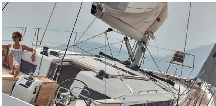
Voici le système de poulies sur pantoire utilisé à bord du Sun Odyssey 440. En rapprochant les poulies de la bôme, la pantoire permet une bonne angulation de la bôme, comme le ferait un rail de Grand-voile sans aucun réglage à faire lors des virements.
