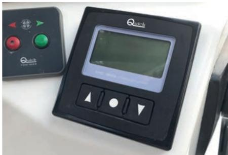
Deuxième commande de guindeau dans le cockpit, avec compteur de chaîne
