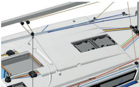
Voici le système de rail utilisé à bord du Sun Odyssey 449. Mettre la bôme dans l'axe nécessite de régler le rail à chaque virement.
